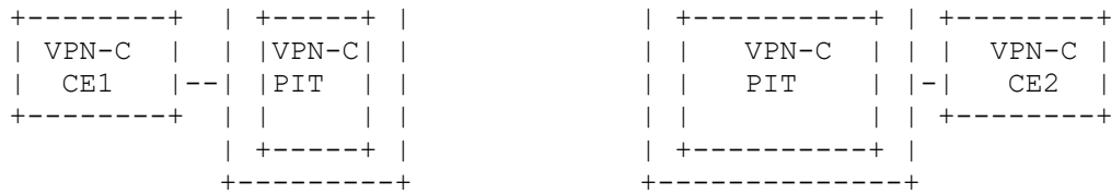
Figure 3 : Mode de base de service L1VPN
