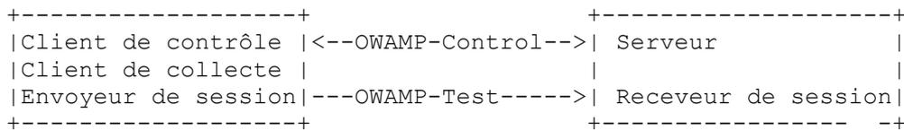
Finalement, comme de nombreux chemins de l'Internet incluent des segments qui transportent IP sur ATM, des mesures de délai et de pertes peuvent inclure les effets de la segmentation et réassemblage (SAR) ATM. Par conséquent, OWAMP a été conçu pour permettre que de petits paquets d'essai tiennent dans la charge utile d'une seule cellule ATM (ceci n'est réalisé qu'en mode non authentifié).
