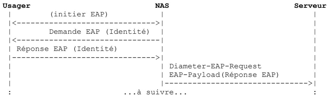
La conversation continue jusqu'à ce que le serveur Diameter envoie une réponse EAP Diameter (Diameter-EAP-Answer) avec une AVP Result-Code indiquant le succès ou l'échec, et une AVP EAP-Payload facultative. L'AVP Result-Code est utilisée par l'appareil d'accès pour déterminer si le service est à fournir au client EAP. L'appareil d'accès NE DOIT PAS s'appuyer sur le contenu de la charge utile EAP facultative pour déterminer si le service est à fournir.
