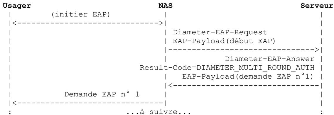
La réponse EAP Diameter initiale dans un échange à plusieurs tours inclut normalement une demande EAP d'identité (EAP-Request/Identity), demandant au client EAP de s'identifier. À réception de la réponse du client EAP (EAP-Response) l'appareil d'accès va alors produire un second message Diameter-EAP-Request, avec la charge utile EAP du client encapsulée dans l'AVP EAP-Payload.
