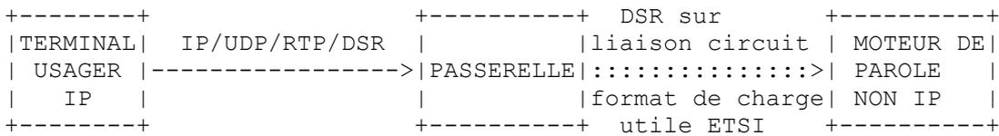
c) Terminal d'utilisateur IP à moteur de parole non IP via une passerelle.
