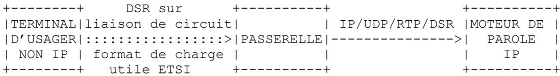
b) Terminal d'utilisateur non IP à moteur de parole IP via une passerelle
