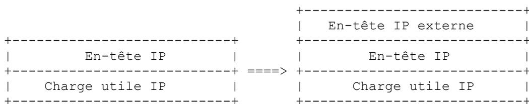
L'adresse de source et l'adresse de destination de l'en-tête IP externe identifient les "points d'extrémité" du tunnel. L'adresse de source et l'adresse de destination de l'en-tête IP interne identifient respectivement l'envoyeur d'origine et le receveur du
